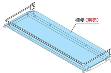
転び止めワイヤーを取り付けることで、薬瓶の落下を未然に防止します。
