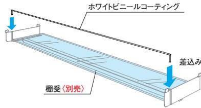
転び止めワイヤーを取り付けることで、薬瓶の落下を未然に防止します。
