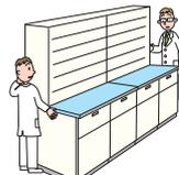
仕器はベースや上部ユニットで連結されているので引きずる事により仕器の破損につながります。
