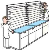
什器はベースや上部ユニットで連結されているので引きずる事により什器の破損につながります。
